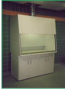
2x DIGESTOŘ KL 12LK se společným prostorem, PD litá keramika:
