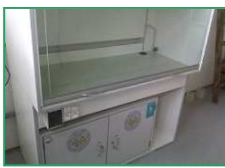
DIGESTOR KL 15K s pracovní deskou Kompakt Max a bezpečnostní skříňkou pro ukládání kyselin a louhů:
